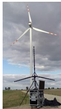
Rys. 5.13 Zdjęcie przedstawiające kamerę akustyczną podczas pomiarów
